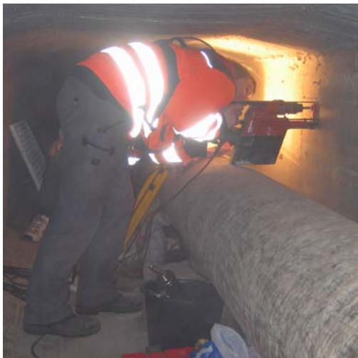
Bohrmehlentnahme im Hohlkasten
