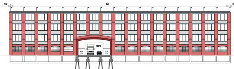
Bild 2: Durchfahrung des Bestandsgebäudes im Anschlussbereich der Weisenauer Straße
